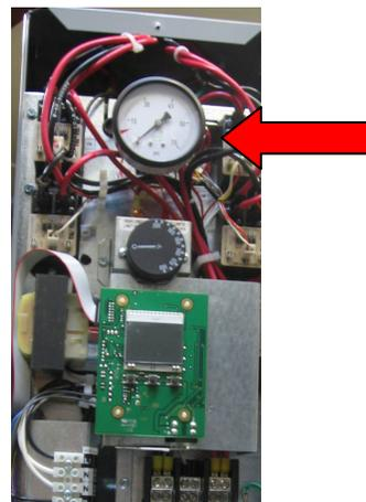
10- Débrancher le fil allant du thermodisque au connecteur de la carte de contrôle
