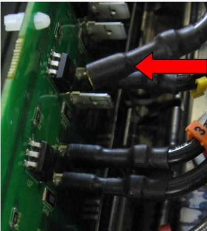
14- Déplacer le fil vers le terminal libre du relais de l'étape 12 (si il s'agit d'un appareil ayant deux alimentations, utiliser un relais connecté au même bornier)
