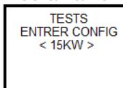
15. Utilisez les flèches haut et bas afin de sélectionner la puissance et appuyez ensuite sur le bouton central afin de valider la sélection
