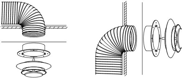
2.7 Repousser le tuyau complètement dans la structure et fixer le collier au plafond ou au mur. Fixer ensuite le diffuseur à son collier.
