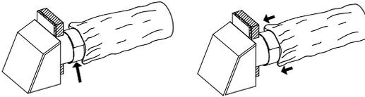
1.6 Recouvrir doucement le joint avec du ruban adhésif de ventilation jusqu'à l'étanchéité complète.
