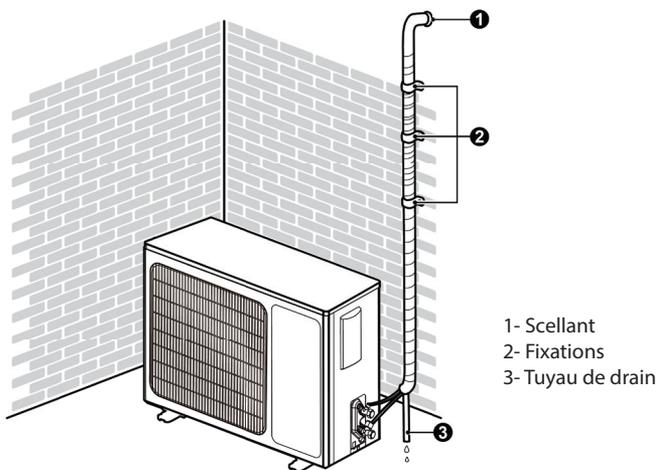
(2) Si l'unité extérieure est au-dessus de l'unité intérieure, disposez le tuyau selon le schéma suivant.
