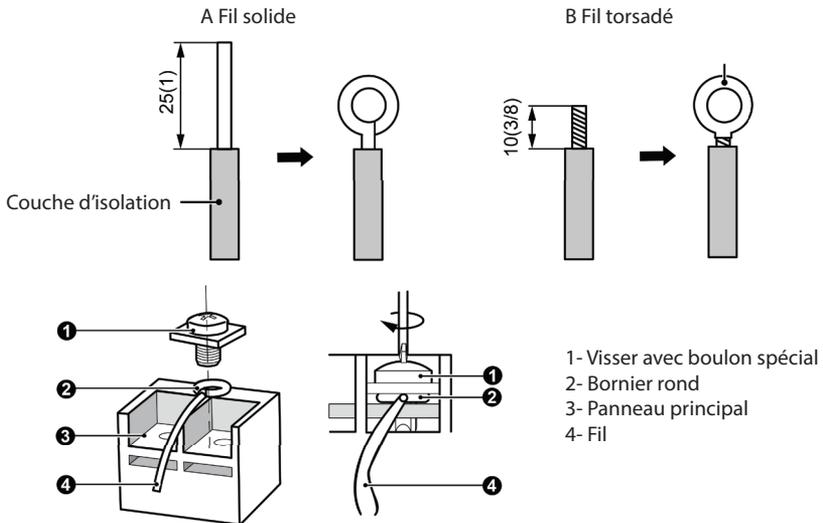
(3) Comment connecter les fils du thermostat et les cordons d'alimentation : Faites passer les fils du thermostat et les cordons d'alimentation à travers le tube isolant (comme illustré dans la figure suivante).
