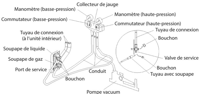
Pour les unités de grande taille, il existe des orifices de maintenance pour la soupape de liquide et la soupape de gaz. Pendant l'évacuation, vous pouvez raccorder les deux tuyaux de l'ensemble de soupape de dérivation aux ports de maintenance pour accélérer l'évacuation.
